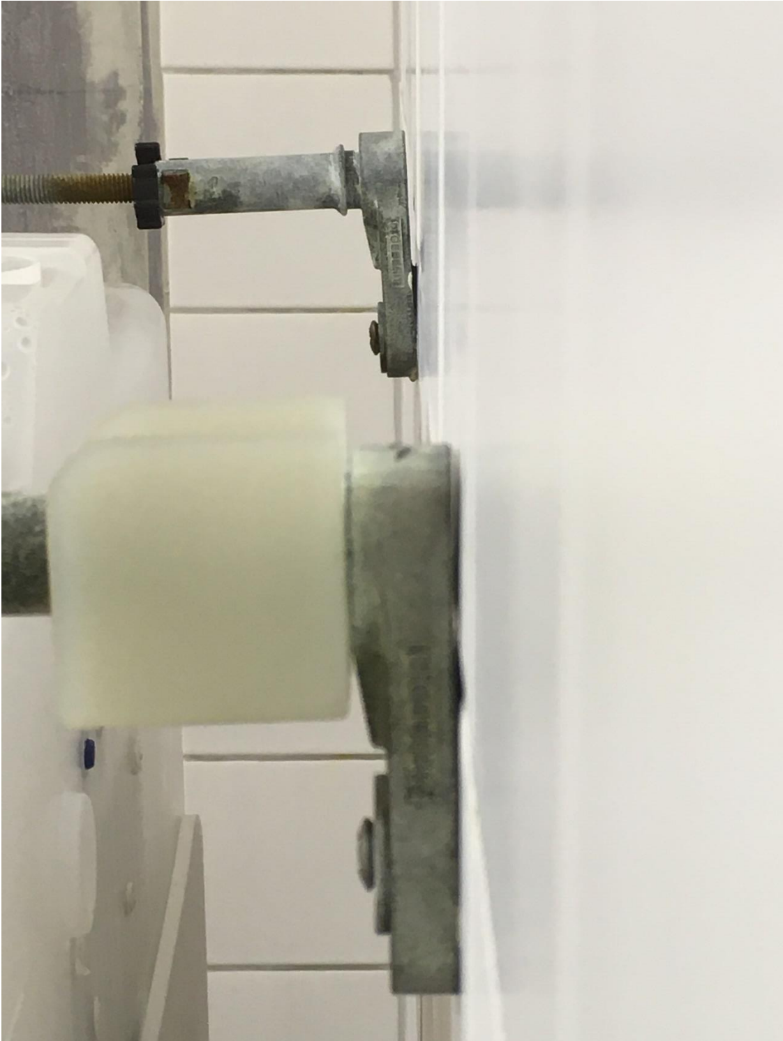
16. Pågående provning. Belastning med statisk last. WC-fixtur.
