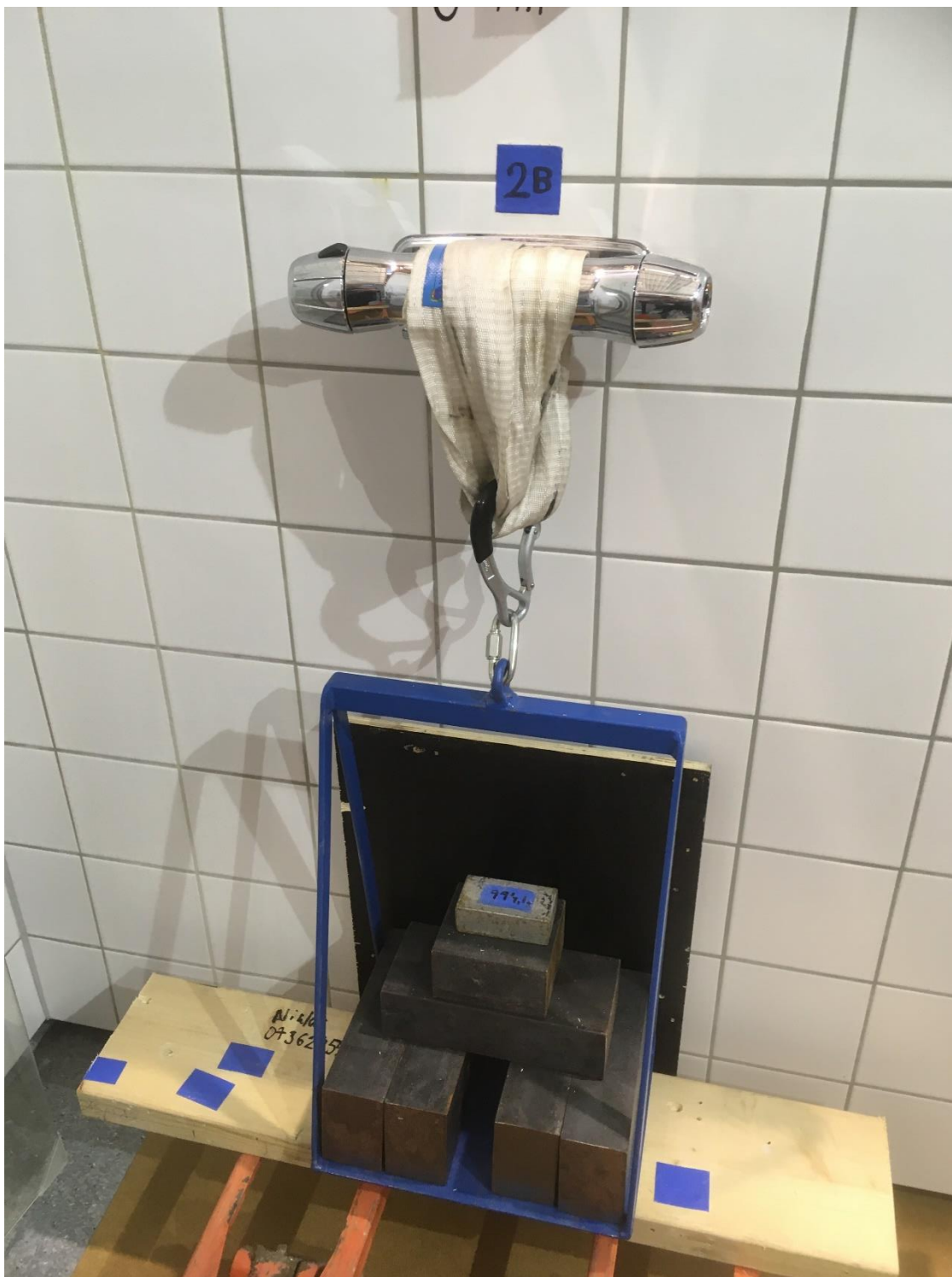
12. Pågående provning. Belastning med statisk last.
