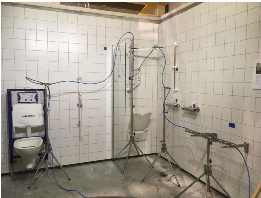
8. Pågående provning. Vattenbegjutning.
