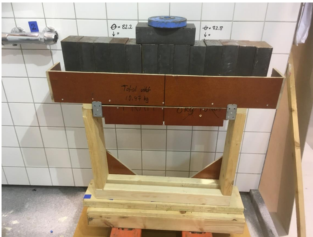
10. Pågående provning. Belastning med statisk last.
