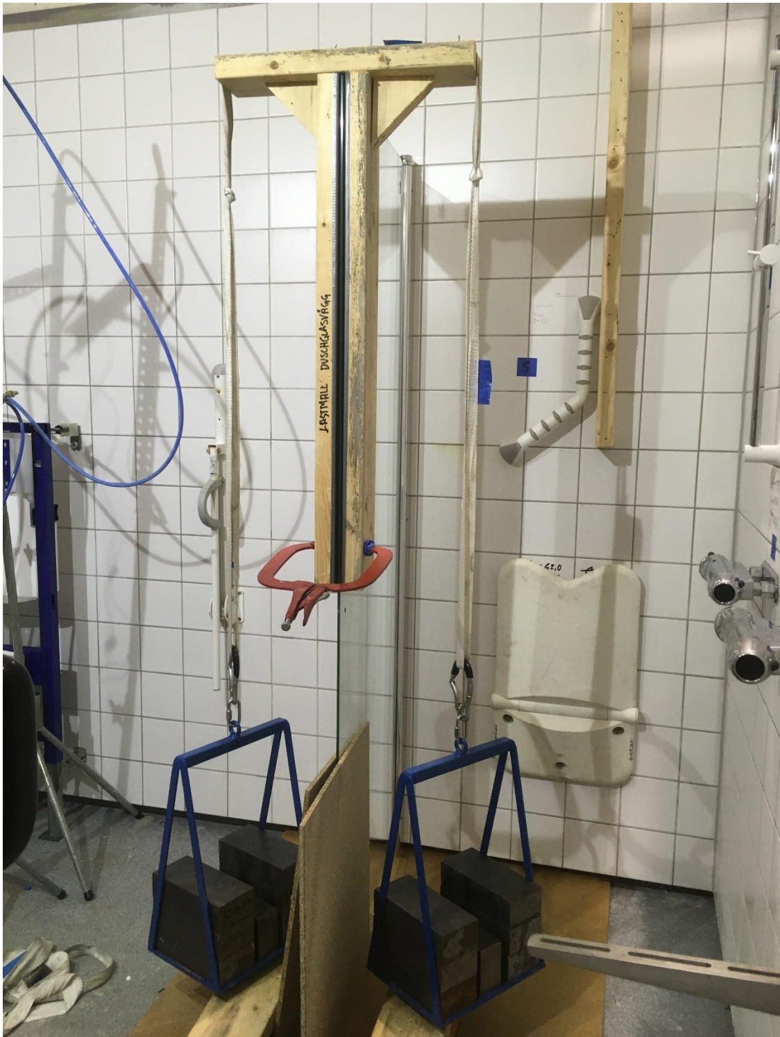
13. Pågående provning. Belastning med statisk last.
