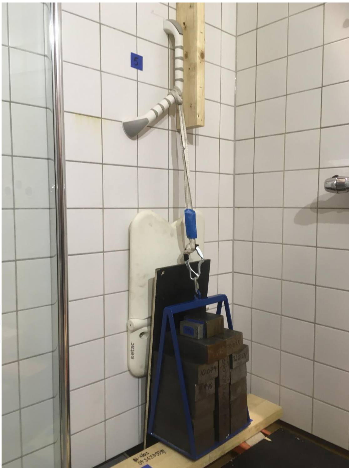
14. Pågående provning. Belastning med statisk last.
