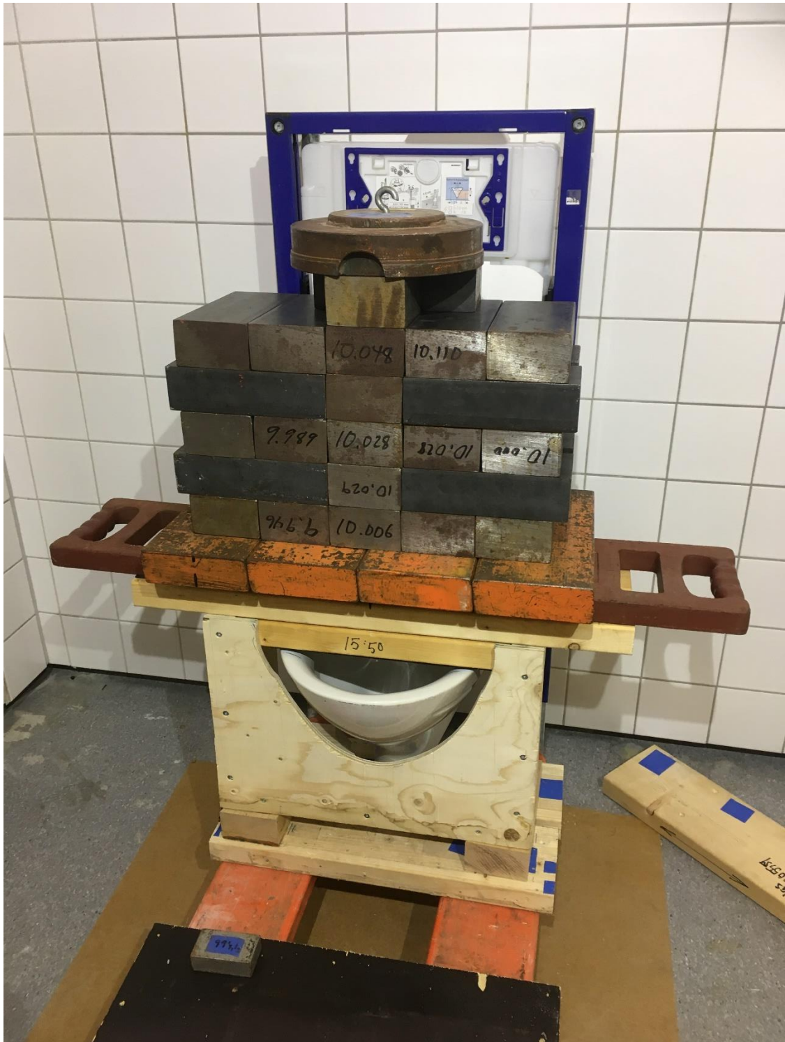
15. Pågående provning. Belastning med statisk last.
